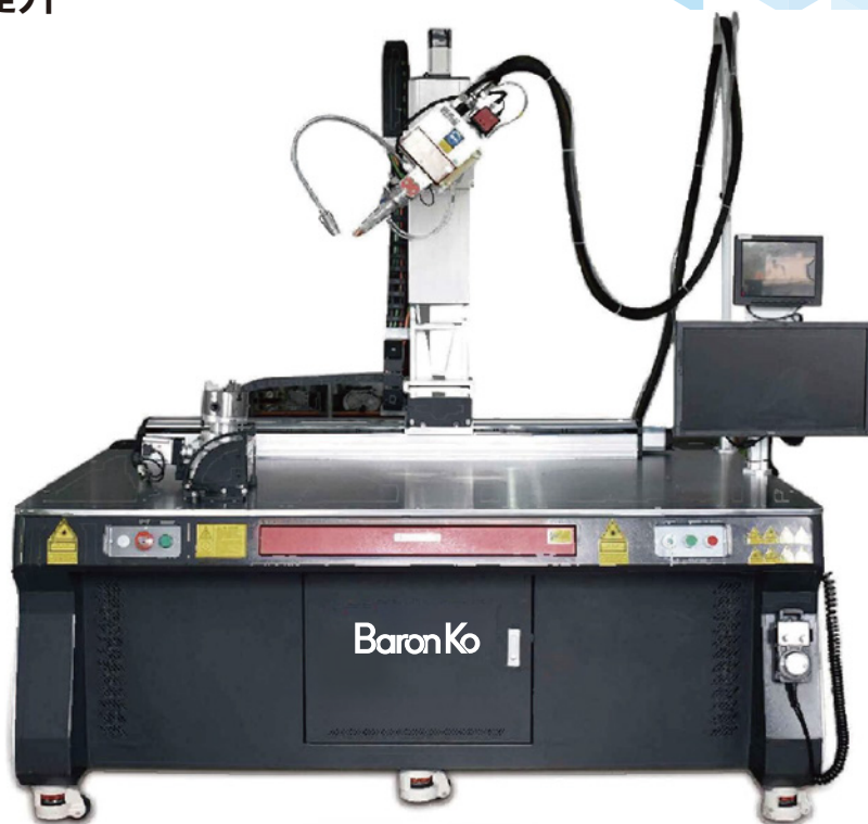
名稱：六軸聯動鐳射焊接機 尺寸：1700*1250*1800mm
