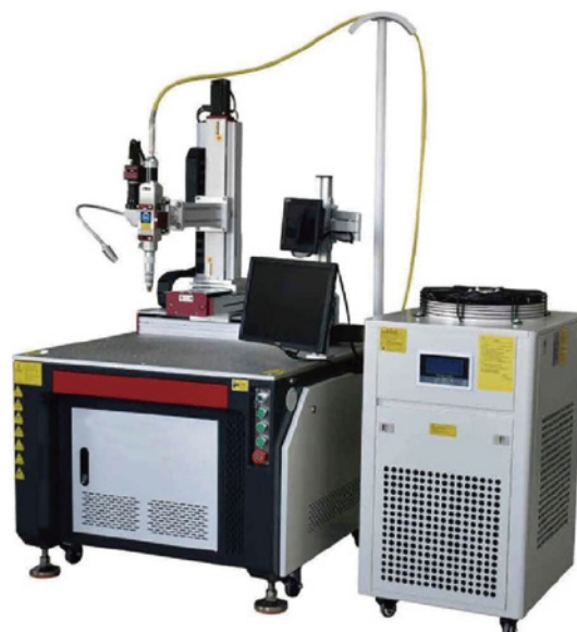
名稱：三軸連續鐳射焊接機 尺寸：800*1200*1650mm
