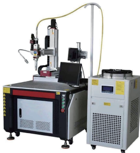
名稱：三軸連續雷射焊接機 尺寸：800*1200*1650mm
