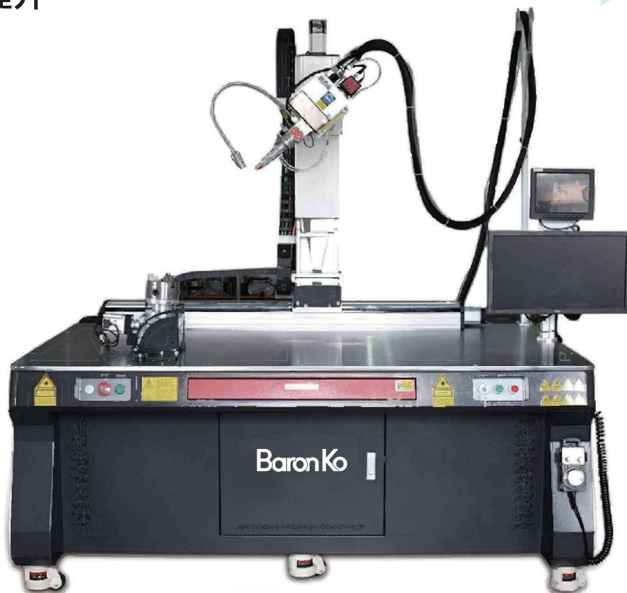
名稱：六軸聯動雷射焊接機 尺寸：1700*1250*1800mm
